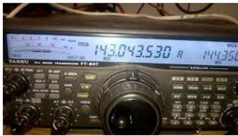
En premier, vous branchez votre récepteur sur l'antenne, vous écoutez la fréquence **143,050 MHz** en **BLU** ou **CW**, et vous devez y entendre des sifflements brefs et variables en force et en fréquence, des " piouuuit " ! : Ce sont les échos de l'émetteur qui émet sur la fréquence, sur des traînées de météorites... là, vous êtes bons pour la suite.
